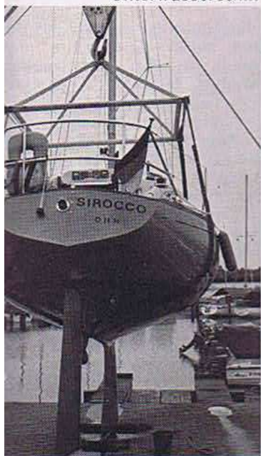
Der gute Wasserablauf erklärt sich durch das jollenförmige Unterwasserschiff
