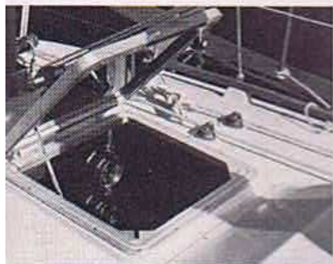
stabiles, wasserdichtes Alu-Luk auf dem Kajütdach. Gut zu erkennen die nach achtern laufenden Fallen
